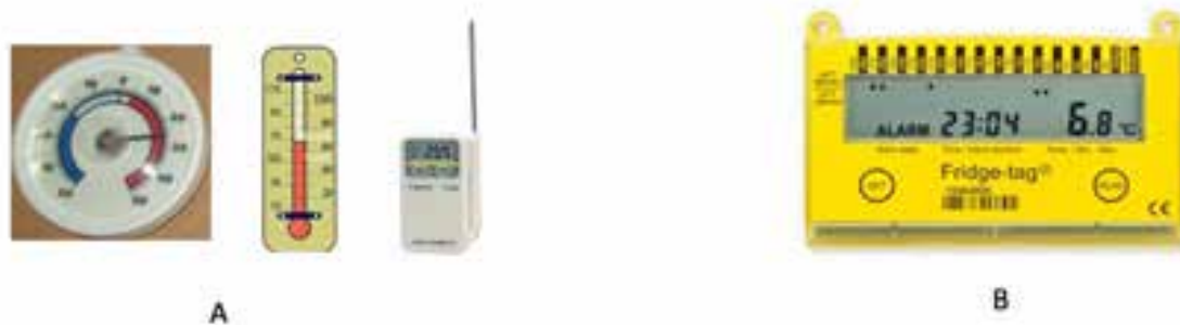
Gambar 4.9 Alat Pemantau Suhu Sesaat (A) dan Berkelanjutan (B) Sumber: Badan Litbangkes, 2010
